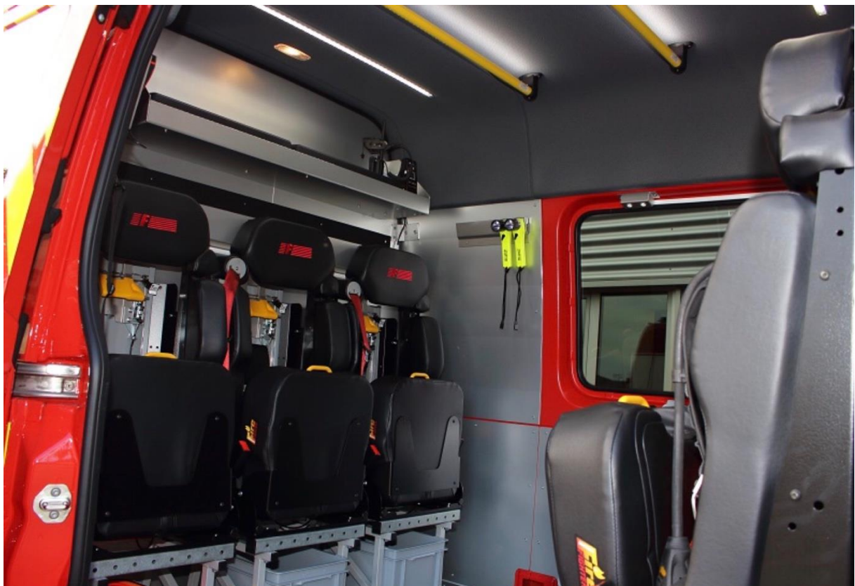
Véhicule Protection Respiratoire Plato 52 / 2024 Aménagement intérieur moderne, avec sièges muni de ceinture de sécurité et intégrant l'appareil respiratoire pour optimiser l'espace à disposition.
